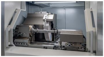
Kompakt: Die GP P60 baut sehr kompakt und alle Komponenten sind in der Umhausung ergonomisch leicht und einfach erreichbar, z.B. zum Schleifscheibenwechsel.
